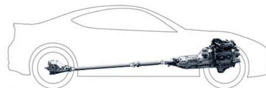
Basso centro di gravità: solo 460 mm da terra.
