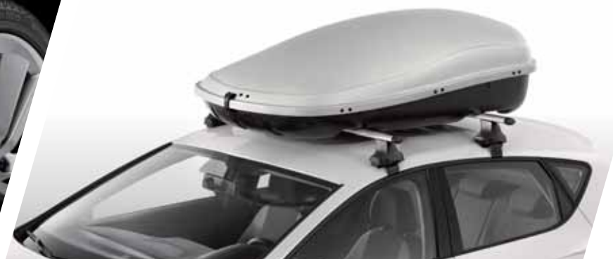
BOX DA TETTO DA 450L. Pareti doppie in plastica resistenti alle intemperie. Peso: 18 kg. Carico massimo: 50 kg. Utilizzato insieme alle barre portatutto*. 000071180A
