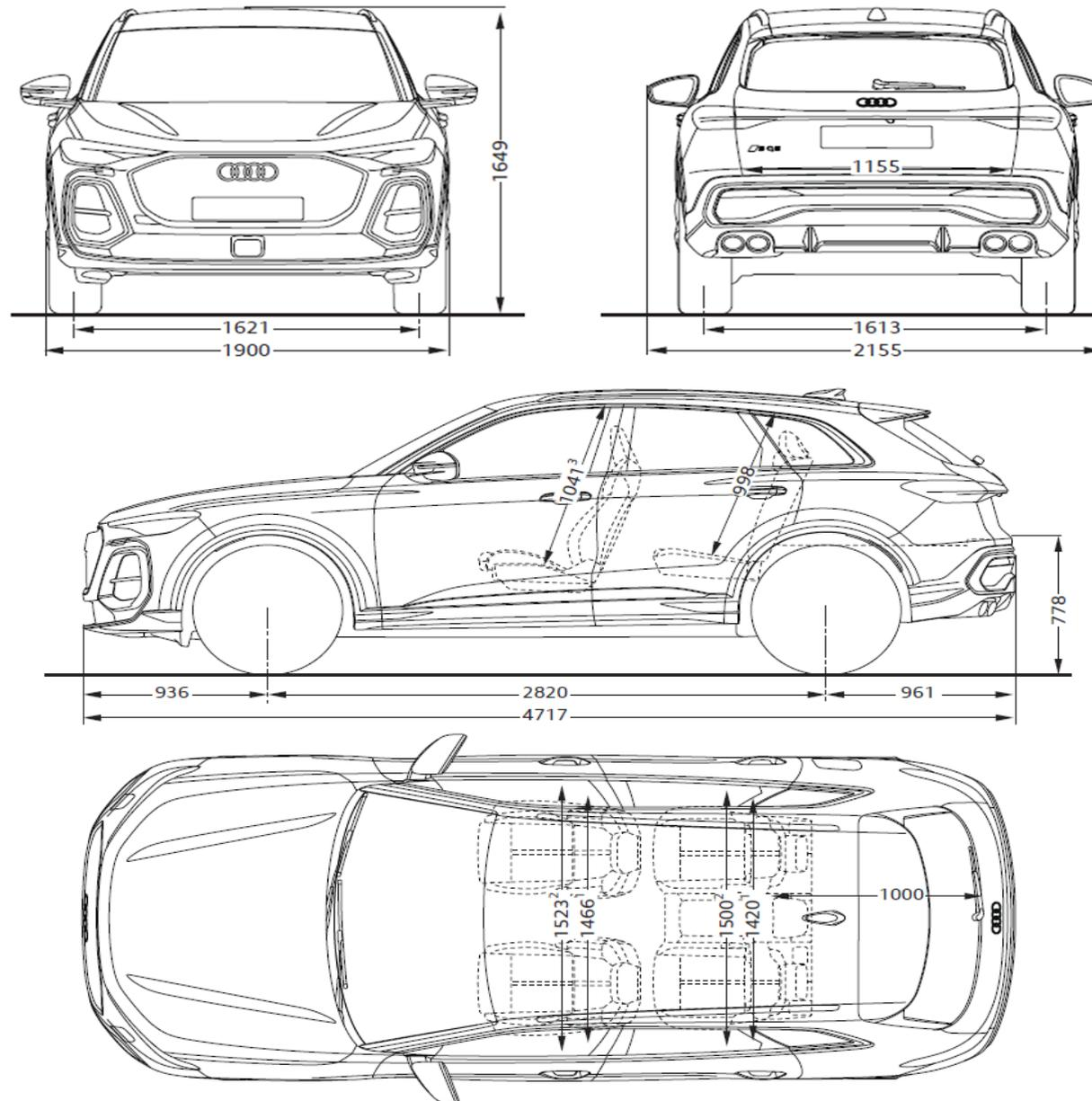
**Misure in millimetri** (indicazione delle dimensioni con massa a vuoto)
