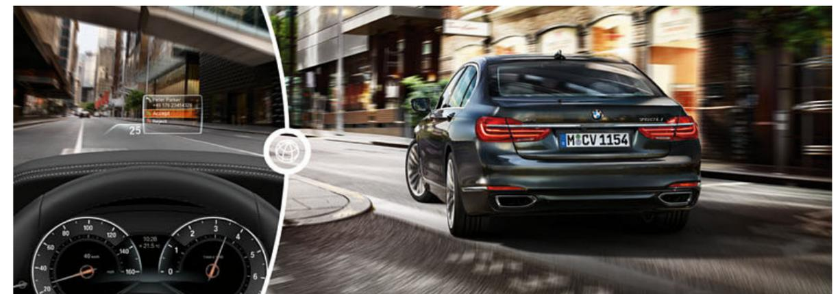
Il **BMW Head-Up Display**<sup>2</sup> interamente multicromatico (optional) visualizza mediante proiezione ottica tutte le informazioni rilevanti per la guida nel campo visivo del guidatore, aiutandolo a concentrarsi sul traffico. Vengono evidenziati tra l'altro la velocità attuale, le indicazioni di navigazione e la Speed Limit Info, compresi i divieti di sorpasso.
