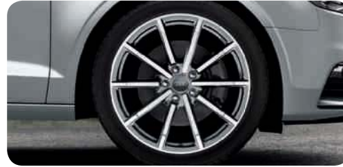
Cerchi in lega di alluminio Audi exclusive a 10 razze in color titanio opaco, torniti a specchio 3 8 J x 18 con pneumatici 225/40 R 18 1 . Una proposta quattro GmbH
