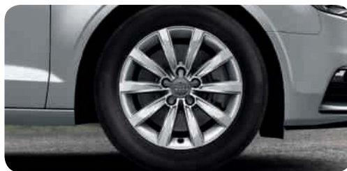
Cerchi in lega di alluminio a 10 razze 7 J x 16 con pneumatici 205/55 R 16 1 (Di serie per A3 Cabriolet versione Attraction)
