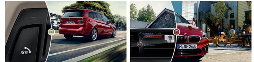
In caso di bisogno, la **chiamata d'emergenza intelligente** (di serie) vi mette automaticamente in collegamento con il centro soccorsi più vicino mediante il BMW Call Center e in modo indipendente dal vostro cellulare. Oltre alla posizione della vettura vengono trasmessi altri dati relativi alla gravità dell'incidente. La chiamata d'emergenza intelligente può essere effettuata anche manualmente, ad esempio per prestare aiuto ad altri utenti della strada.
