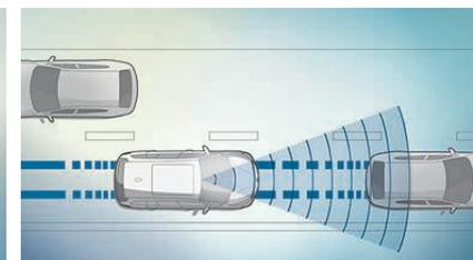
■ L'**avvisatore di possibile tamponamento con funzione city brake<sup>2</sup>** aiuta attivamente il guidatore ad evitare tamponamenti o a ridurne la gravità, avvisandolo per tempo fino a una velocità di 60 km/h. Al tempo stesso predispose i freni a una risposta più rapida e con l'optional Driving Assistant frena automaticamente nei casi d'emergenza.
