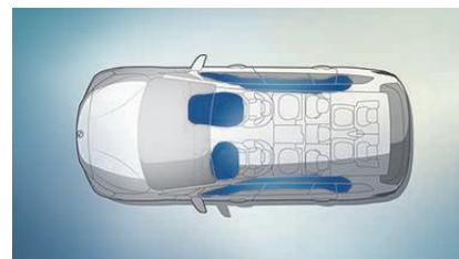
■ Gli **airbag per guidatore e passeggero** fanno parte del sistema di sicurezza BMW nel quale tutti i componenti sono armonizzati con precisione. Sei airbag offrono ai passeggeri una protezione ottimale: airbag anteriori, airbag per la testa per tutta la superficie dei cristalli laterali e airbag laterali integrati negli schienali dei sedili anteriori.
