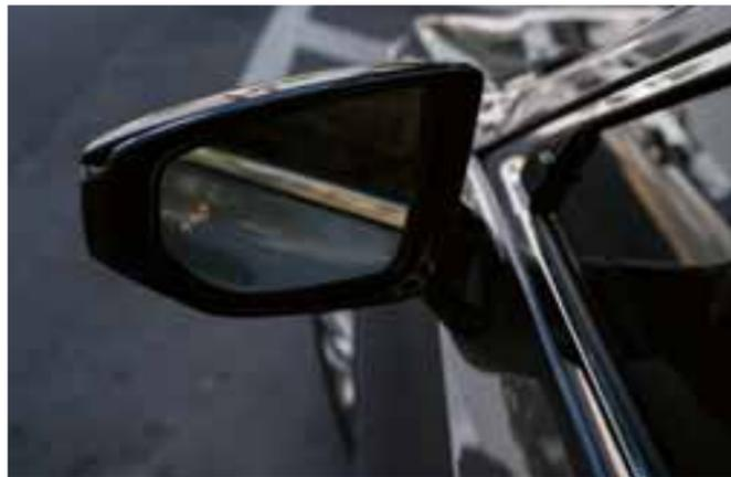
In caso di pericolo, il sistema trasmette un allarme visivo che permette al guidatore di intervenire tempestivamente per evitare l'impatto e, all'occorrenza, intervenire anche autonomamente sui freni qualora il conducente non dovesse farlo.
