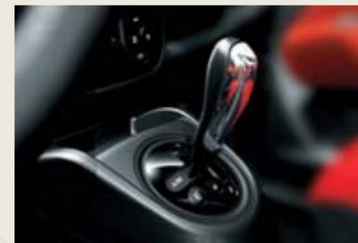
Cambio robotizzato Dualogic™ a 5 marce con le due modalità sequenziale ed automatico e dotato anche della funzione ECO che, ottimizzando i cambi marcia, riduce consumi ed emissioni.
