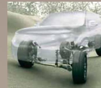
**Nel fuoristrada.** Nella guida in fuoristrada le ruote di Land Cruiser agiscono in maniera indipendente, rimanendo saldamente a contatto con il terreno per offrire costantemente la massima trazione. Lo stabilizzatore è disattivato. Il liquido può scorrere liberamente nel sistema e ogni singola ruota può così adattarsi liberamente alla conformazione del terreno. Questa maggiore escursione delle sospensioni consente una trazione e una stabilità ottimali anche sui terreni più accidentati.
