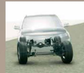
**Su strada.** Le sospensioni ad alta reattività lavorano in sinergia con le barre antirollio per garantire la massima agilità dello sterzo. Gli stabilizzatori anteriori e posteriori sono collegati idraulicamente. Il sistema elettronico KDSS agisce su una serie di valvole collegate ad accumulatori che bilanciano in modo ottimale l'azione degli stabilizzatori anteriori e posteriori, per poter così assorbire ogni irregolarità del terreno.
