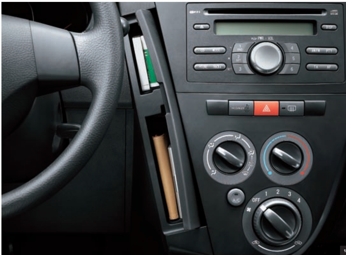
1. Vano portaoggetti a doppio scomparto. 2. Doppio vano portaoggetti centrale (versioni senza radio). 3. Cassetto portaguanti. 4. Luci di cortesia a spegnimento ritardato. 5. Alette parasole con specchio di cortesia e portabiglietti (lato guidatore).
