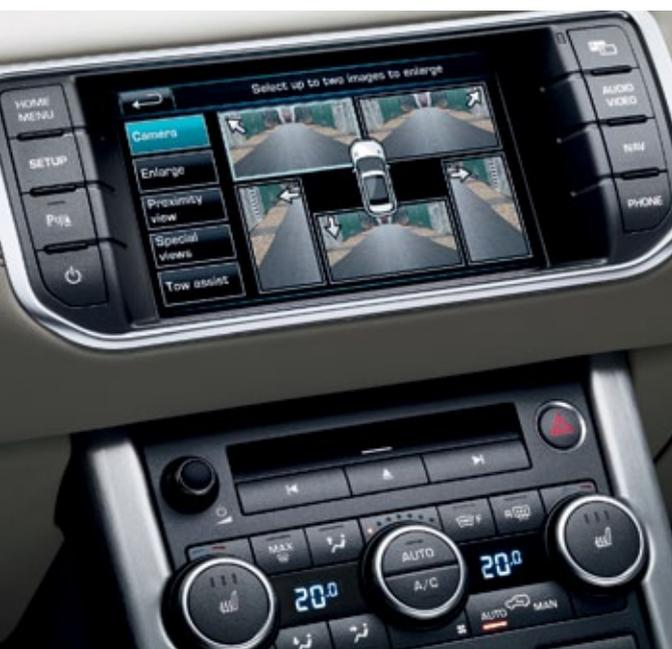
Il Surround Camera System, sistema di telecamere esterne, utilizza cinque telecamere digitali posizionate in modo discreto per visualizzare sul touch-screen nella plancia una visuale di quasi 360 gradi. Il sistema fornisce diversi ausili per il guidatore e può risultare inestimabile durante le manovre su strada e in fuoristrada. Le cinque telecamere digitali sono alloggiare all'esterno del veicolo: due davanti, una su ciascun lato del veicolo e una dietro.
