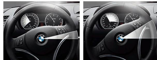
Alle basse velocità il volante deve essere sterzato di meno per mantenere la traiettoria in curva.
