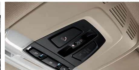
Attivazione manuale della chiamata d'emergenza dall'unità di comando sul tetto.
