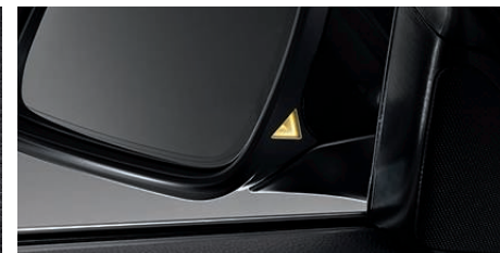
Il triangolo segnala che una vettura si trova nell'«angolo cieco».
