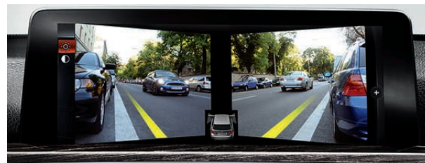
Side View visualizza il traffico ai lati della vostra BMW sul Control Display.
