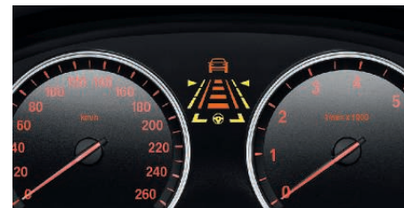
L'Assistente di Guida in colonna mantiene automaticamente la distanza che si desidera dai veicoli che precedono e la propria BMW al centro della corsia selezionata.
