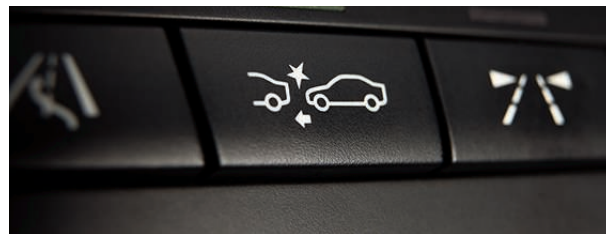
L'Avvisatore del rischio di tamponamento si accende e si spegne manualmente.
