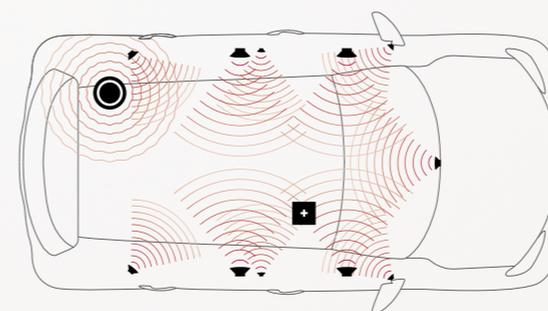
**Il JBL Soundsystem** (a richiesta) integra il Media-System o l'Audio-System con una sonorità convincente. I dodici altoparlanti ad elevate prestazioni, incluso un subwoofer estraibile posto nel bagagliaio e un amplificatore con potenza complessiva di 320 Watt, assicurano un sound potente.
