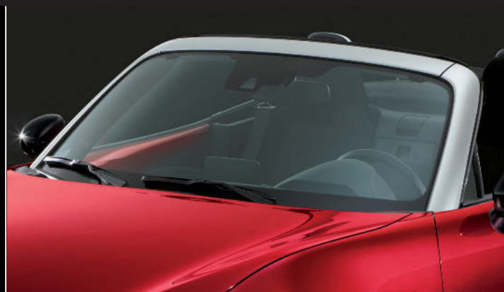
RIVESTIMENTO DEL MONTANTE A.
