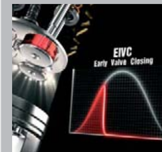
EIVC (Early Intake Valve Control) Chiusura anticipata della valvola Coppia a basso regime e pieno carico Es: motore in accelerazione
