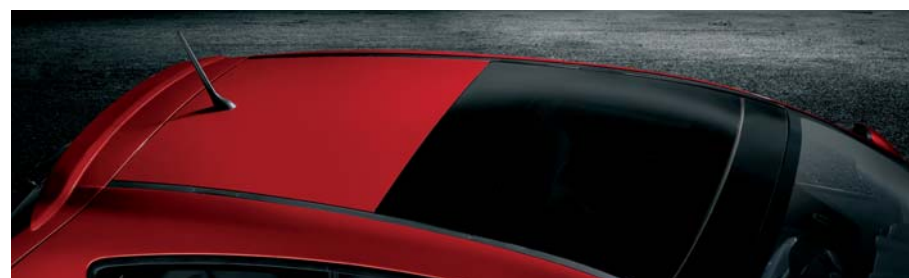
Tetto apribile elettrico - Chiuso
