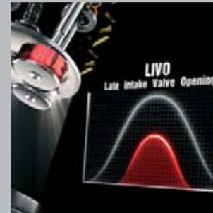
LIVO (Late Intake Valve Opening) Apertura ritardata della valvola Carico parziale del motore Es: accensione o motore al minimo
