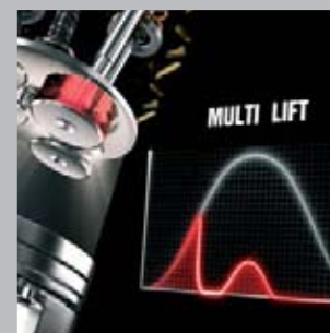
MULTI LIFT Apertura multipla nello stesso ciclo Coppia e potenza minime Es: guida in città
