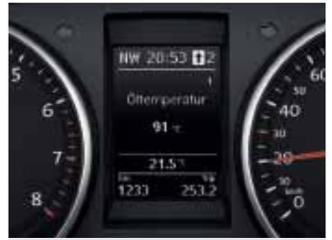
Il display multifunzionale "Plus" indica la velocità media, il consumo di carburante, il tempo di percorso e la temperatura dell'olio. Segnala se ci sono delle porte aperte, propone la lingua da selezionare e consente di impostare la velocità massima (più adatta) per i vostri pneumatici.
