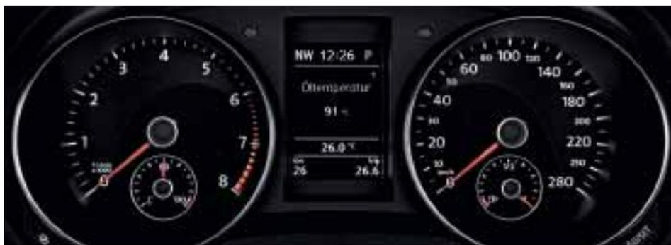
Grazie alla **luce bianca dell'illuminazione** regolabile della strumentazione le informazioni sono facili da leggere anche in condizioni di luce avverse. Lo strumento combinato dispone inoltre, di serie, del display multifunzionale Plus con l'indicazione di cambio marcia che vi consente di rimanere sempre nel range del numero di giri ottimale.
