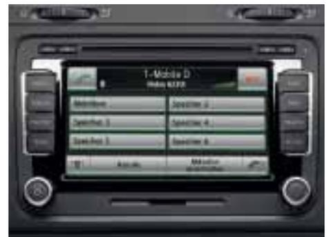
La predisposizione per telefono cellulare "Premium"<sup>1)</sup> è un dispositivo vivavoce che risponde alle massime esigenze di comfort. Il vostro cellulare si collega autonomamente all'antenna esterna della vettura, consentendovi di usarlo senza doverlo estrarre.
