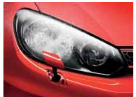
L'impianto lavafari fa parte del pacchetto inverno che comprende anche i sedili anteriori riscaldabili, una spia luminosa per il livello dell'acqua e gli ugelli lavavetro anteriori riscaldabili.
