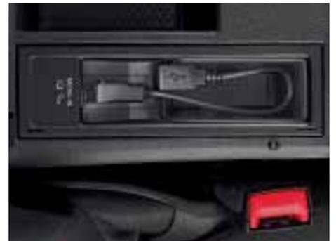
La presa multimediale MEDIA-IN<sup>2)</sup> nel bracciolo centrale è completa di interfaccia USB e consente il collegamento di fonti audio esterne tramite la radio o il navigatore satellitare.
