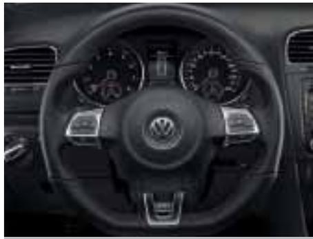
Il volante multifunzionale in pelle vi permette, l'uso confortevole del navigatore satellitare e del telefono cellulare. In abbinamento con il cambio a doppia frizione DSG consente, inoltre, di cambiare le marce direttamente dal volante, tramite le apposite leve del cambio.
