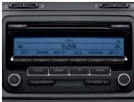
La radio "RCD 310" dispone di lettore CD, otto altoparlanti e presa multimediale AUX-IN. Può riprodurre file nel formato MP3 o WMA e dispone di una potenza in uscita di 4 x 20 Watt.
