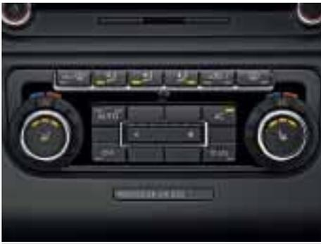
Il sistema di climatizzazione "Climatronic" dispone di regolazione della temperatura separata per il conducente ed il passeggero anteriore. Un sensore rileva la qualità dell'aria attivando, all'occorrenza, il comando di ricircolo.
