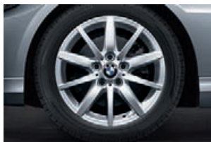
□ Cerchi in lega leggera da 17" styling a stella n° 286 con pneumatici misti Runflat, ant. 8 J x 17, pneumatici 225/45 R 17, post. 8,5 J x 17, pneumatici 255/40 R 17. Di serie per 325i/xDrive, 330i/xDrive, 335i/xDrive, 325d, 330d/xDrive e 335d versione Attiva.
