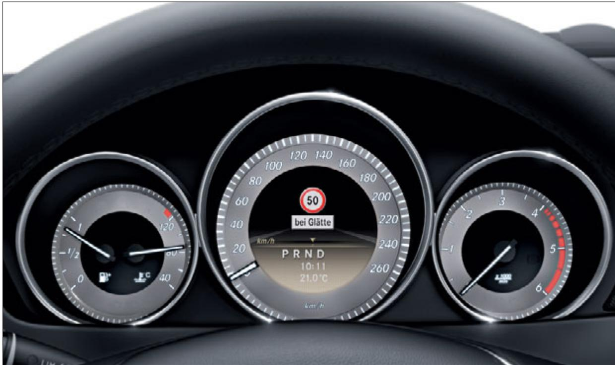
Lo Speed Limit Assist informa il guidatore sui limite di velocità in vigore sul tratto di strada che sta percorrendo.
