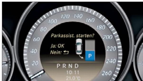
Ad una velocità fino a 36 km/h, l'ACTIVE PARKTRONIC calcola automaticamente la lunghezza dello spazio di parcheggio.
