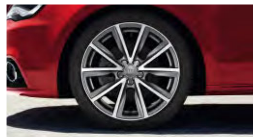
■ Cerchi in lega di alluminio a 5 razze a V, antracite, parzialmente lucidi, 7,5 J x 17 con pneumatici 215/40 R 17
