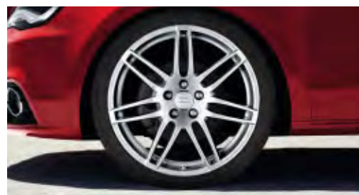
■ Cerchi in lega di alluminio Audi exclusive a 7 razze doppie 1 , 7,5 J x 18 con pneumatici 225/35 R 18. Una proposta quattro GmbH
