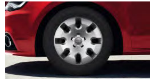
□ Cerchi in acciaio con coprip ruota integrali, 6 J x 15 con pneumatici 185/60 R 15 (solo per 1.2 TFSI Attraction)
