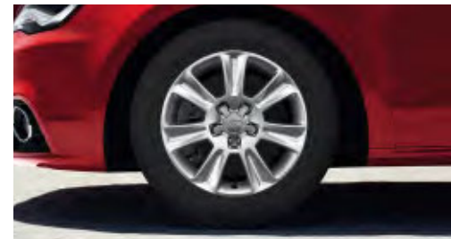
□ Cerchi in lega di alluminio a 7 razze, 6,5 J x 15 con pneumatici 205/55 R 15 (di serie per la motorizzazione 1.4 TFSI e 1.6 TDI Attraction, optional per la motorizzazione 1.2 TFSI Attraction)
