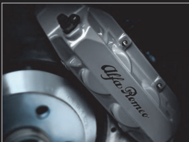
Freni anteriori Dual-cast autoventilanti forati 305x28 con pinza fissa a 4 pistoncini Brembo
