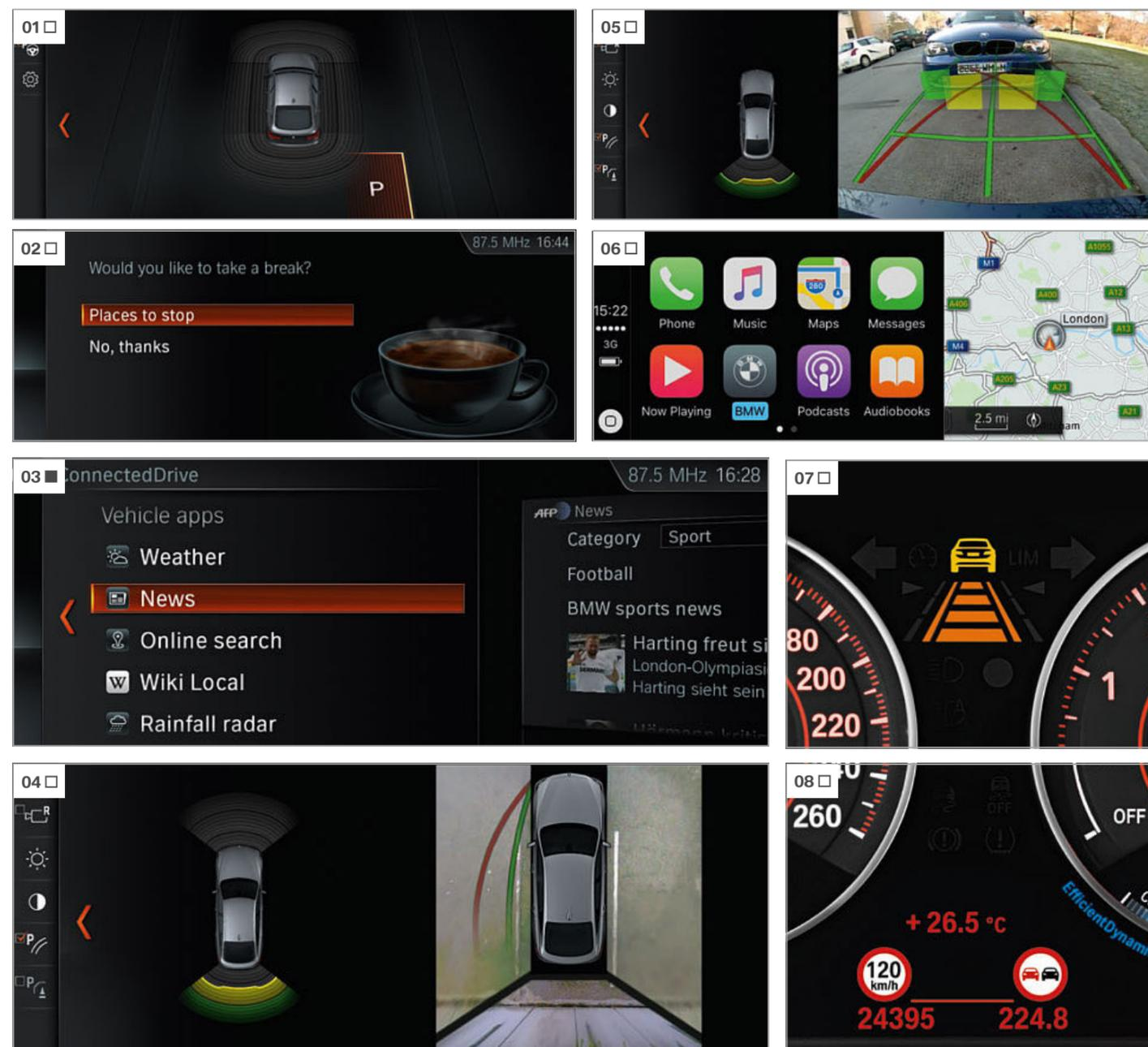
**[ 01 ]** Il Park Assistant facilita le manovre di parcheggio parallele e trasversali alla corsia di marcia. Agisce sullo sterzo mentre in conducente mantiene il comando dell'acceleratore, del freno e del cambio.
