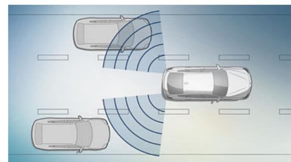
□ Il **Segnalatore di sorpasso pericoloso<sup>1</sup>** attira l'attenzione del conducente con una segnalazione visiva e una leggera vibrazione del volante, nel caso in cui rilevi la presenza di veicoli nella corsia vicina o nell'angolo cieco.
