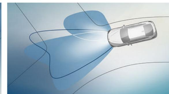
□ I **fari adattivi LED** emettono una luce simile a quella naturale diurna e regolano automaticamente la distribuzione della luce in base alla velocità del veicolo e all'angolazione di sterzo.
