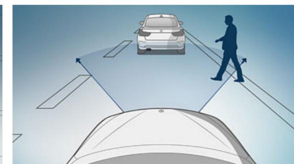
□ La **segnalazione di persone con funzione di frenata City<sup>1</sup>** indica al conducente il rischio di potenziali collisioni con i pedoni e può frenare automaticamente la vettura in situazioni di emergenza.
