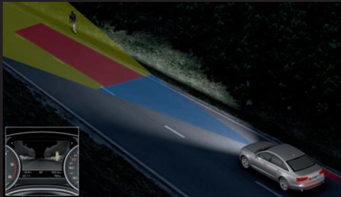
Quando il sistema rileva il pericolo di collisione, l'evidenziazione passa dal giallo al rosso e viene emesso un segnale acustico.
