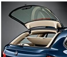
■ **Lunotto, apribile separatamente:** mediante il telecomando si solleva separatamente per caricare o scaricare comodamente e rapidamente i bagagli. Un aspetto particolarmente pratico è che all'apertura l'avvolgibile di copertura si solleva automaticamente, per poi abbassarsi di nuovo alla chiusura manuale del portellone.
