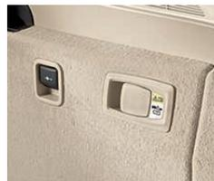
■ **Sblocco a distanza dei sedili posteriori:** mediante una maniglia è possibile sbloccare comodamente lo schienale posteriore e abbattearlo in avanti per ottenere un fondo del vano bagagli praticamente in piano.
