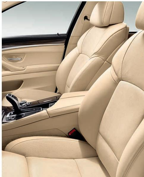
**Sedili sportivi anteriori:** offrono un sostegno laterale ottimale grazie ai fianchi dei sedili più alti e alla possibilità di regolare elettricamente l'altezza del sedile e l'inclinazione dello schienale. Regolazione manuale per inclinazione del sedile, posizione longitudinale e appoggio gambe (di serie M550d xDrive).
