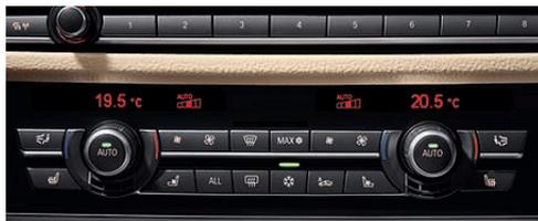
■ **Climatizzatore automatico con regolazione a 2 zone:** con filtro dell'aria ricircolata, sensore appannamento, ventilazione a vettura ferma e utilizzo del calore residuo nonché regolazione automatica della temperatura (separata per guidatore e passeggero).
