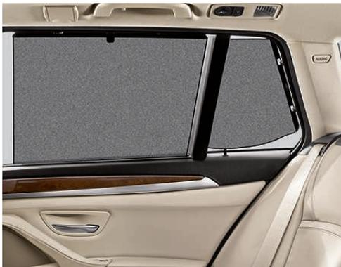
□ **Tendina parasole avvolgibile elettricamente** per i finestrini delle portiere posteriori.
