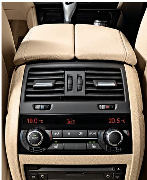
□ **Climatizzatore automatico con regolazione a 4 zone:** dotazione identica al climatizzatore automatico a 2 zone e funzionalità ampliate, con in più bocchette dell'aria nel montante centrale e bocchette comfort davanti nella plancia strumenti per una ventilazione senza fastidiose correnti d'aria; è inoltre possibile regolare individualmente la temperatura nella zona posteriore mediante un elemento di comando nel display (di serie per 550i e M550d xDrive).
