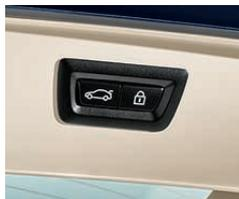
□ **Portellone elettrico:** il portellone si apre automaticamente mediante telecomando a onde radio e si chiude tramite i tasti nella modanatura di maniglia. L'apertura è a comando elettromeccanico. Aprendo il portellone la copertura avvolgibile si solleva automaticamente e si abbassa di nuovo chiudendolo (di serie per M550d xDrive).
