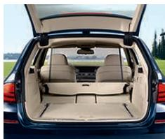
■ **Copertura avvolgibile con rete divisoria:** aprendo il portellone o il lunotto la copertura si solleva per agevolare le operazioni di carico e scarico. Nel caso di una frenata brusca il bagagliaio rimane fermo nel bagagliaio.
