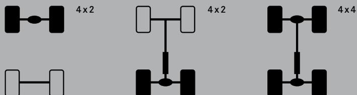
Primo veicolo commerciale del suo segmento, il Vito Tourer è disponibile in tre tipologie di trazione: anteriore, posteriore e integrale.
