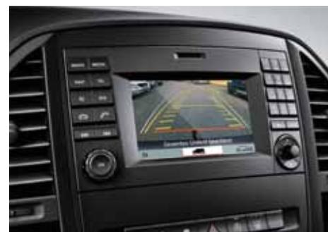
○ Con l'ausilio di linee dinamiche, la **telecamera per la retromarcia assistita** restituisce immagini fotorealistiche dei dintorni e in direzione di marcia del veicolo.
