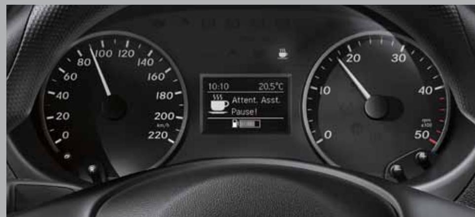
Basandosi sull'elaborazione di numerosi parametri, l'ATTENTION ASSIST (di serie) è in grado di rilevare i tipici sintomi di affaticamento e allertare così il guidatore.
