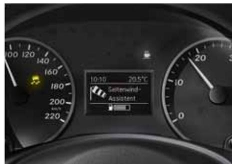
● Il sistema di assistenza in presenza di vento laterale (**Crosswind Assist**) contribuisce a evitare sbandamenti in caso di forti raffiche di vento laterale.
