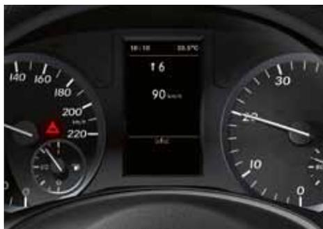
○ Il **COLLISION PREVENTION ASSIST**<sup>1</sup> combina la segnalazione della distanza e l'avvertimento contro il rischio di collisione con il Brake Assist BAS PRO.
