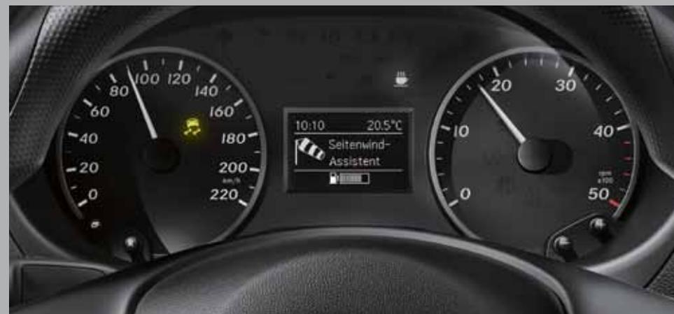
Il sistema di assistenza in presenza di vento laterale (Crosswind Assist), incluso nella dotazione di serie, contribuisce a evitare sbandamenti in caso di forti raffiche di vento laterale.
