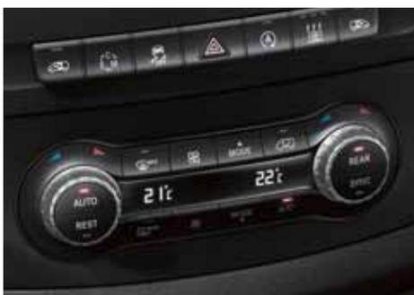
○ Il **climatizzatore automatico COMFORTMATIC** regola automaticamente temperatura, portata e ripartizione dell'aria, separatamente per guidatore e passeggero anteriore.
