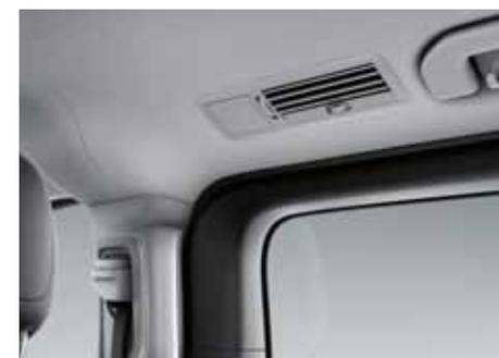
○ Il **climatizzatore a regolazione semiautomatica TEMPATIC** nel vano posteriore ottimizza la ventilazione nel vano passeggeri distribuendo uniformemente l'aria calda o fredda (di serie per trazione posteriore/integrale).
