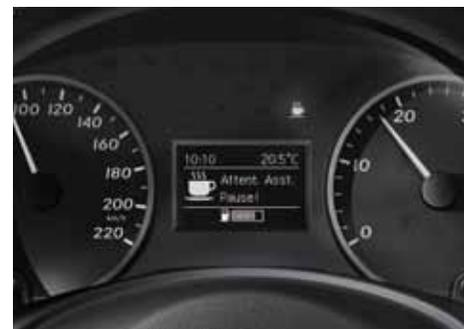
● Basandosi sull'elaborazione di numerosi parametri, l'**ATTENTION ASSIST** è in grado di rilevare i tipici sintomi di affaticamento e allertare così il guidatore.
