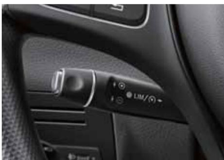
○ Il **TEMPOMAT** permette di mantenere la velocità impostata alleggerendo il compito del guidatore.
