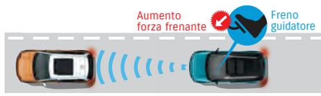
Condizioni di funzionamento: Entra in funzione a velocità pari o superiori a 5 km/h
