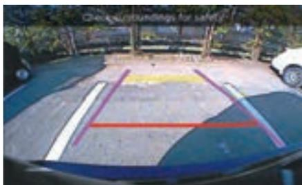
La retrocamera posteriore con misuratore di distanza riproduce le immagini sul display centrale da 7" garantendoti un utile supporto per le operazioni di retromarcia.
