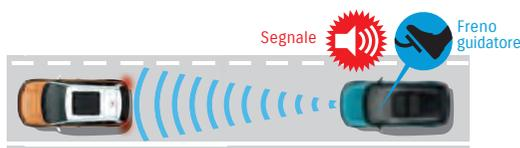
Condizioni di funzionamento: Contro ostacoli fermi: entra in funzione a velocità tra 5 e 80 km/h
