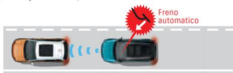
Condizioni di funzionamento: Contro ostacoli fermi: entra in funzione a velocità tra 5 e 30 km/h
