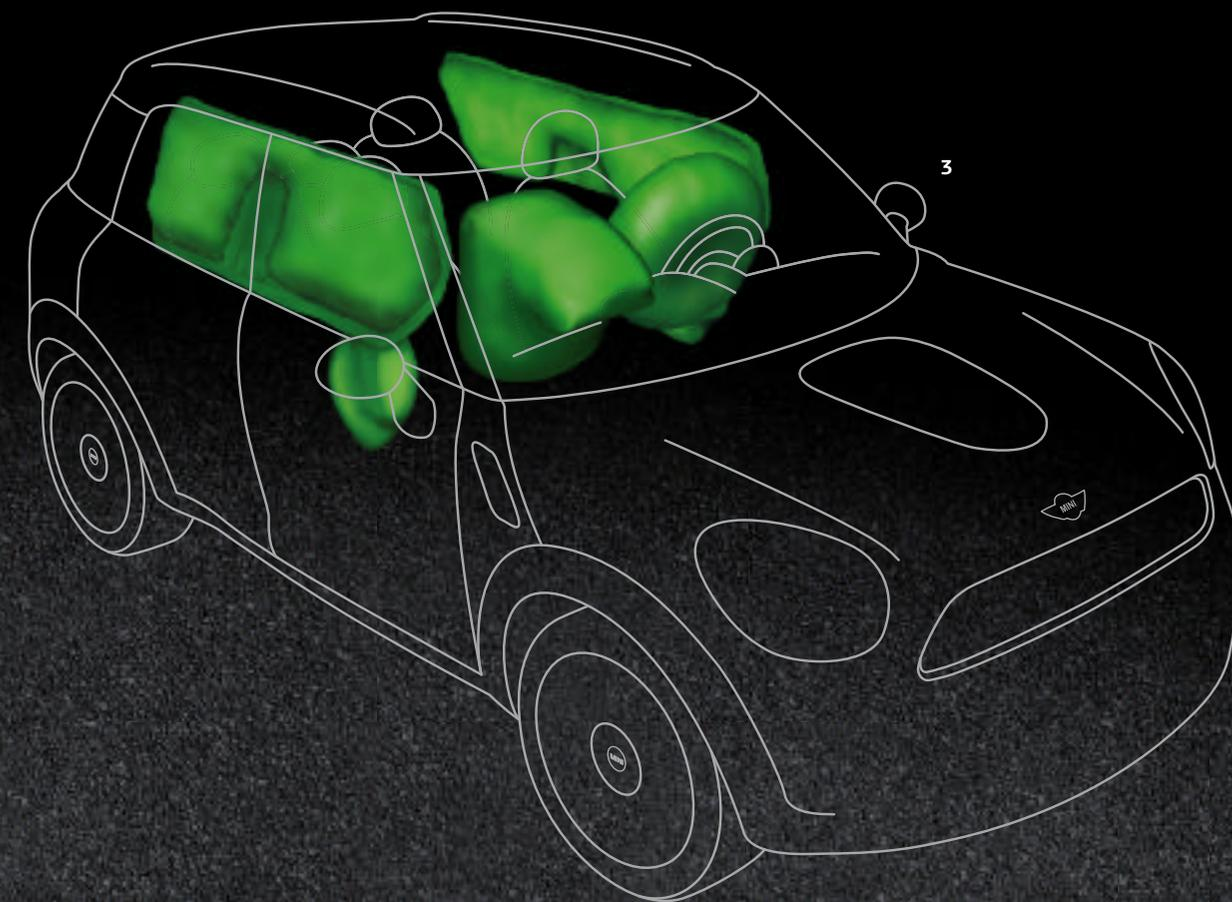
**1 SISTEMA DI RITENZIONE.** In caso di impatto il guidatore ed il passeggero sono protetti da una combinazione ben orchestrata di elementi di sicurezza: cinture inerziali a 3 punti, pretensionatori e limitatori di ritenzione.
