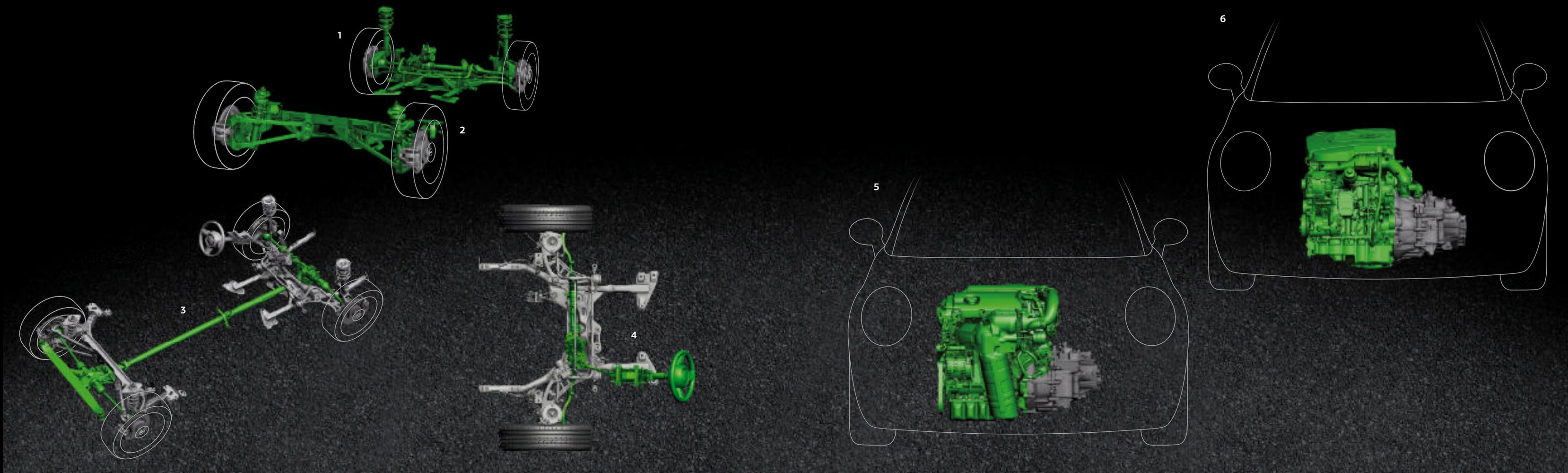
**1 ASSALE ANTERIORE A SNODO SINGOLO E MONTANTI MOLLEGGIATI.** Due semiassi della stessa lunghezza all'avantreno riducono l'influsso della trazione sullo sterzo, ottimizzando il comportamento della vettura in curva, in accelerazione ed in frenata.
