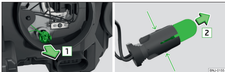
Fig. 208 Sostituzione della lampadina della luce di posizione
