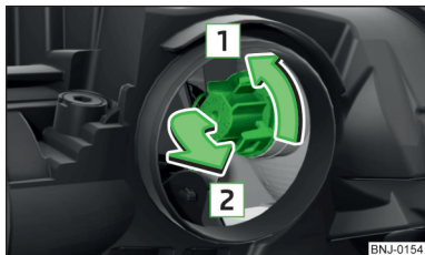
Fig. 207 Sostituzione della lampadina per indicatore di direzione anteriore
