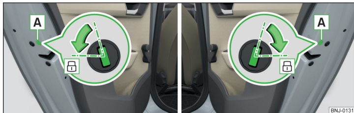
Fig. 194 Bloccaggio di emergenza: porta posteriore sinistra/destra
