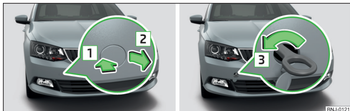
Fig. 190 Smontaggio della calotta di copertura / montaggio dell'occhione di traino
