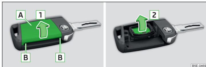
Fig. 192 Chiave con comando a distanza: Rimozione del coperchio / rimozione della batteria
