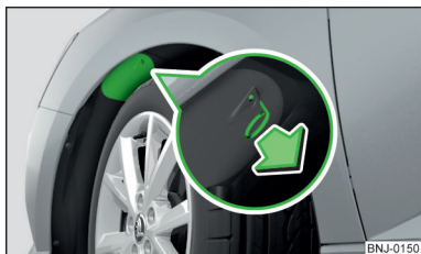
Fig. 204 Smontaggio del coperchio in plastica
