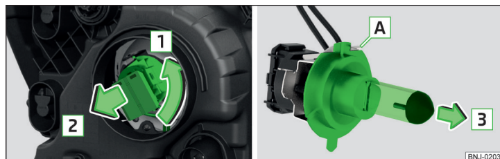
Fig. 211 Sostituzione della lampadina per gli abbaglianti
