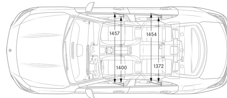
Tutti i dati sono espressi in millimetri. I valori raffigurati sono da intendersi medi e validi per vetture con equipaggiamento di base e senza carico.
