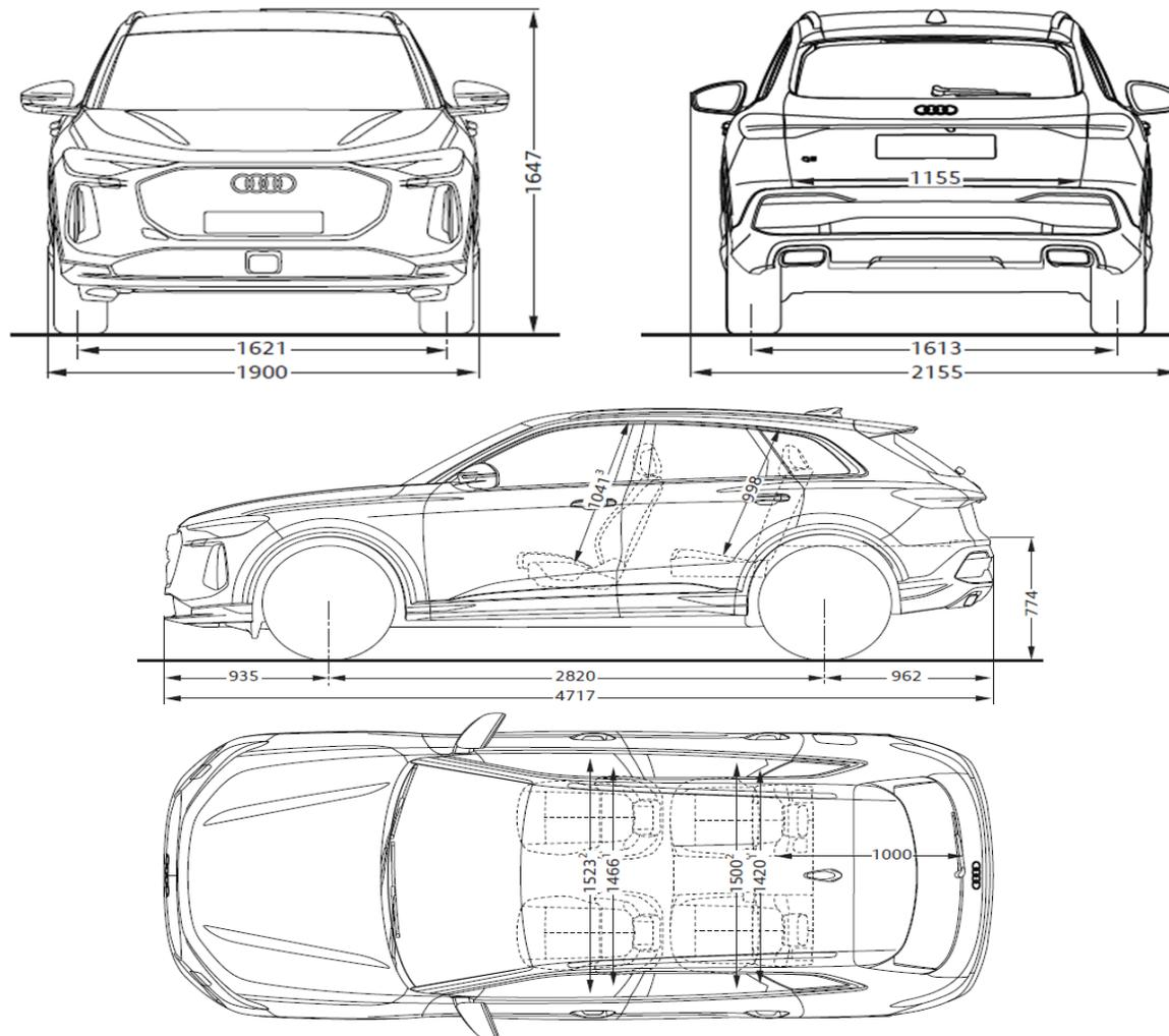
**Misure in millimetri** (indicazione delle dimensioni con massa a vuoto)
