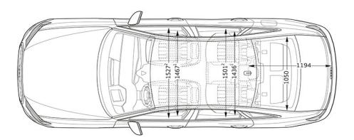
Misure in millimetri (indicazione delle dimensioni con massa a vuoto)
