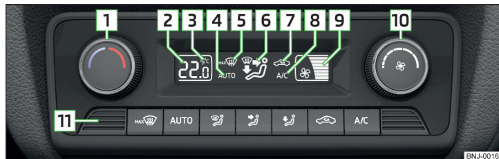
Fig. 118 Elementi di comando del Climatronic
