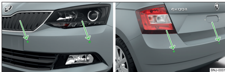
Fig. 133 Posizione di montaggio dei sensori sul lato sinistro del veicolo: anteriore/posteriore
