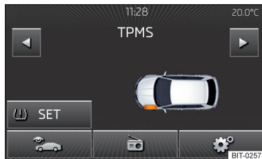
Fig. 148 Tasto per la memorizzazione dei valori di pressione / esempio di visualizzazione su display: il sistema presenta una variazione di pressione sui pneumatici anteriori a sinistra
