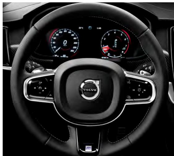
Il volante R-Design rivestito in pelle Nappa traforata con le leve del cambio opzionali e il quadro strumenti digitale da 12,3" con quattro modalità grafiche.
