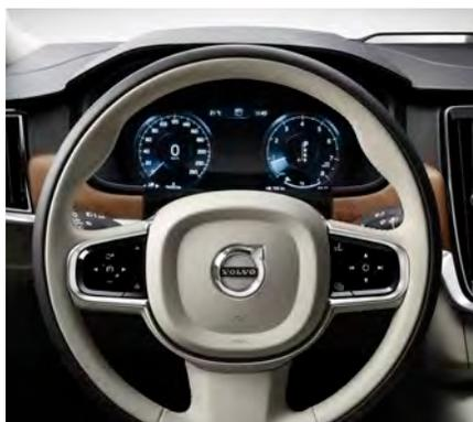
Dal sedile conducente puoi controllare ogni funzione della vettura. Funzionalità come la navigazione e l'intrattenimento possono essere gestite dai comandi al volante; il quadro strumenti da 12,3" ti tiene informato.
