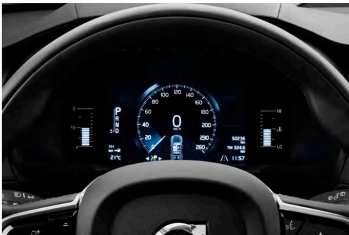
Il quadro strumenti digitale da 8" permette di scegliere tra diverse modalità grafiche. Per fornire un'ottima visibilità, la lucentezza del display si adatta automaticamente alle condizioni di luce esterna.
