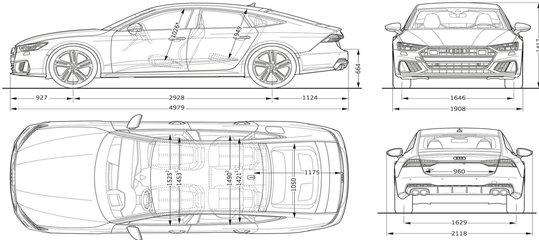
**Misure in millimetri** (indicazione delle dimensioni con massa a vuoto)
