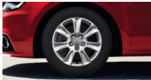
Cerchi in lega di alluminio a 7 razze, 6,5 J x 15 con pneumatici 205/55 R 15 (esclusivi per 1.4 TFSI 122 CV e 1.6 TDI 105 CV Attraction)
