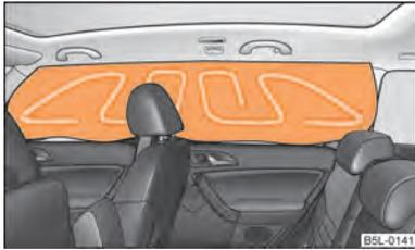
Fig. 128 Airbag per la testa gonfio
