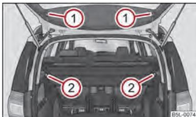
Fig. 61 Smontaggio della cappelliera
