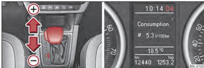
**Fig. 107** Leva selettoria: cambio manuale delle marce / display informativo: Cambio manuale delle marce
