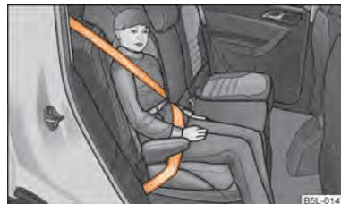
Fig. 134 Seggiolino per bambini del gruppo 3 montato nel senso di marcia sul sedile posteriore
