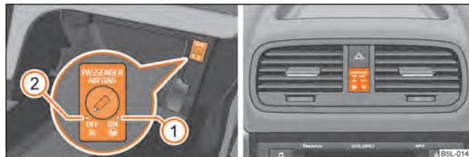
**Fig. 129** Scomparto portaoggetti: Interruttore per airbag frontale lato passeggero / spia di controllo per disabilitazione airbag lato passeggero
