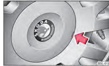
Fig. 167 Rimozione delle coppe con ruote con cerchi in lega
