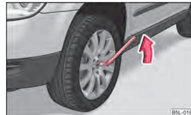
Fig. 168 Sostituzione di una ruota: Allentamento dei bulloni
