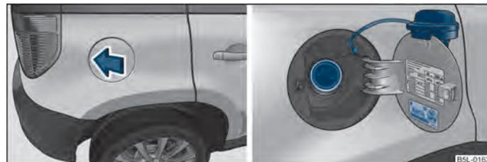
Fig. 150 Lato vettura posteriore destro: Apre lo sportello serbatoio / Sportello serbatoio con tappo a vite
