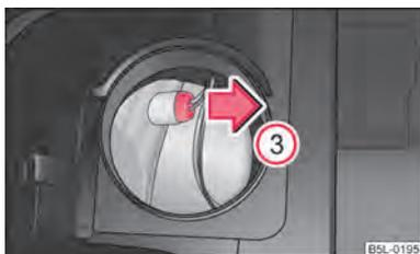
Fig. 183 Smontaggio della sede della luce di posizione (fari allo xeno)
