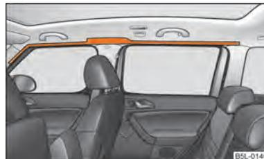
Fig. 127 Ubicazione dell'airbag per la testa
