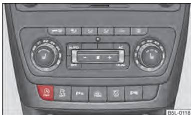
Fig. 105 Plancia: tasto del sistema START-STOP
