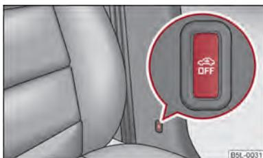
Fig. 18 Tasto della sorveglianza abitacolo e della protezione antirimozione
