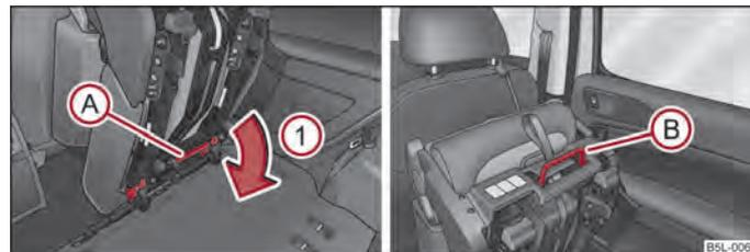
Fig. 52 Sbloccaggio del sedile ribaltato / maniglia sul cuscino
