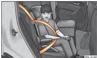
Fig. 133 Seggiolino per bambini del gruppo 2 montato nel senso di marcia sul sedile posteriore
