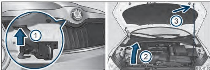
Fig. 152 Griglia radiatore: Leva di bloccaggio / Fermo del cofano motore con sostegno
