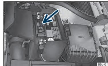
Fig. 158 Batteria: Indicazione del livello dell'elettrolito
