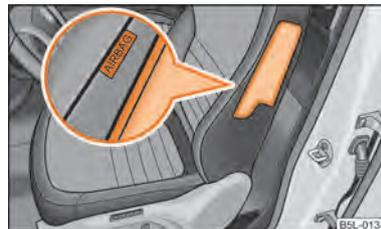
Fig. 125 Ubicazione dell'airbag laterale nel sedile conducente
