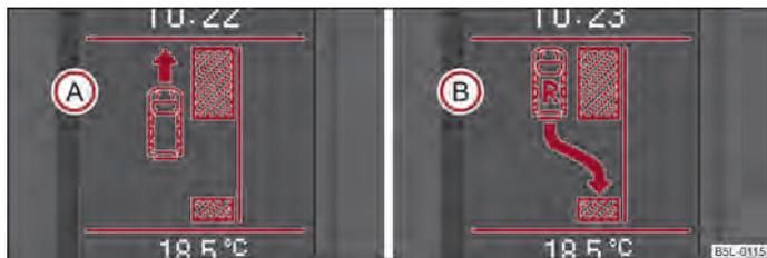
Fig. 102 Display informazioni: area di parcheggio rilevata con indicazione a procedere la marcia (A) e innesto della retromarcia (B)
