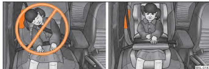
**Fig. 130** Bambino non assicurato correttamente e con posizione sedile non corretta - pericolo rappresentato dall'airbag laterale / bambino seduto correttamente in un seggiolino
