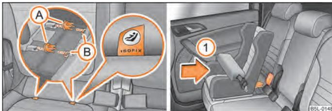
Fig. 135 Occhielli di ritegno (sistema ISOFIX) / Introduzione del seggiolino ISOFIX negli adattatori precedentemente montati
