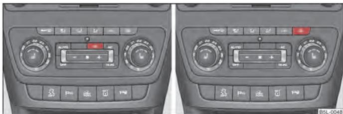
Fig. 35 Interruttore riscaldamento parabrezza / interruttore lunotto termico
