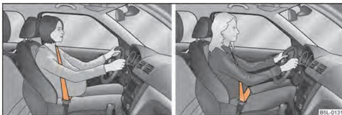
Fig. 118 Posizione del nastro della cintura per le donne incinte / posizione del nastro diagonale e del nastro addominale della cintura
