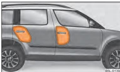
Fig. 126 Airbag laterale riempito con gas
