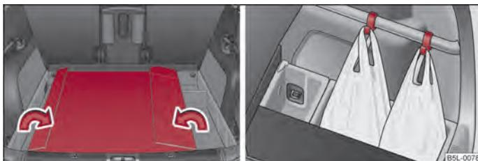
Fig. 65 Bagagliaio: ribaltare i lati del piano di carico / esempio per l'utilizzo del piano di carico variabile
