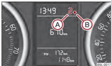
Fig. 4 Suggerimento per il passaggio di marcia
