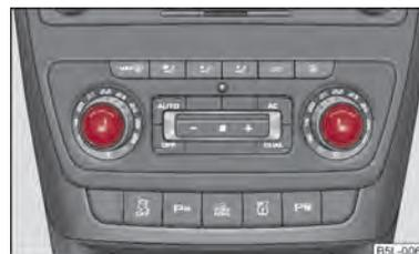
Fig. 56 Plancia: Regolatore riscaldamento sedili anteriori
