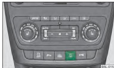
Fig. 139 Tasto per la regolazione del valore di controllo per la pressione dei pneumatici
