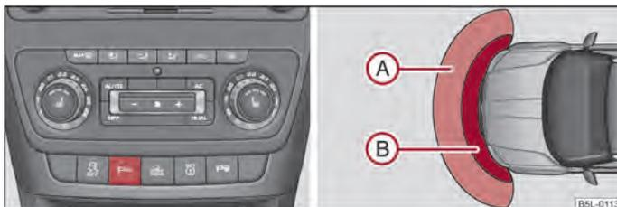
Fig. 100 Attivazione del sistema di segnalazione ausiliario / zona di rilevamento dei sensori anteriori
