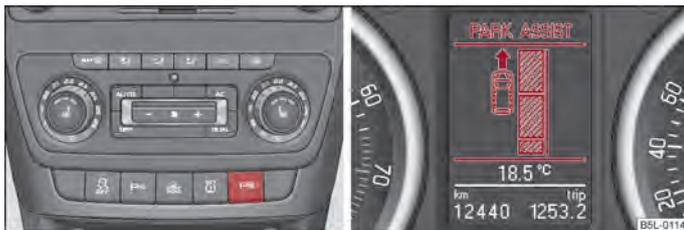
Fig. 101 Inserimento dell'assistenza al parcheggio / display informazioni: Trovare un'area di parcheggio adatta
