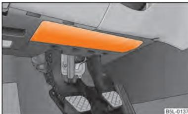
Fig. 124 Airbag ginocchia conducente sotto il piantone sterzo
