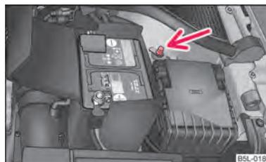
Fig. 174 Avviamento d'emergenza di vetture con il sistema START-STOP
