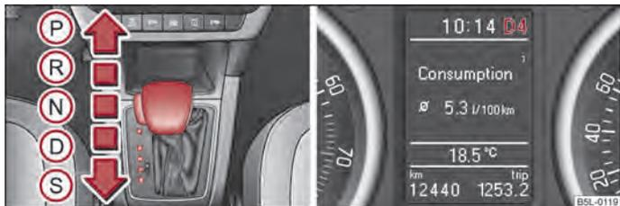
Fig. 106 Leva selettoria / display informazioni: Posizioni della leva selettoria
