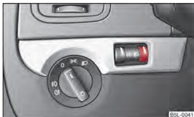
Fig. 28 Plancia: Regolazione assetto fari
