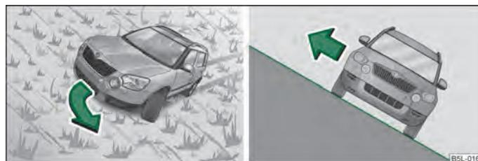
**Fig. 149** Sterzare nella linea di pendenza / direzione da cui scendere dal veicolo - lato rivolto verso l'alto del pendio
