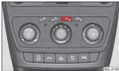
Fig. 93 Tasto per l'inserimento/disinserimento diretto del riscaldamento supplementare (riscaldamento e ventilazione autonomi) sul pannello comandi del climatizzatore
