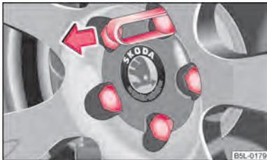
Fig. 166 Rimozione dei cappucci
