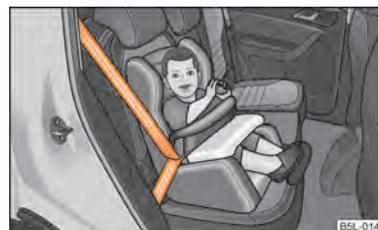
Fig. 132 Seggiolino per bambini del gruppo 1 con tavolino di sicurezza montato nel senso di marcia sul divano posteriore
