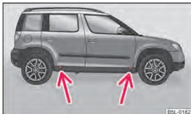
Fig. 169 Sostituzione di una ruota: punti di applicazione del martinetto
