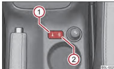
Fig. 13 Consolle centrale: Tasto per la chiusura centralizzata
