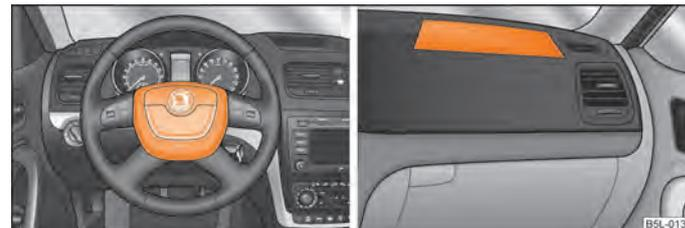
Fig. 121 Airbag conducente nel volante / airbag passeggero nella plancia
