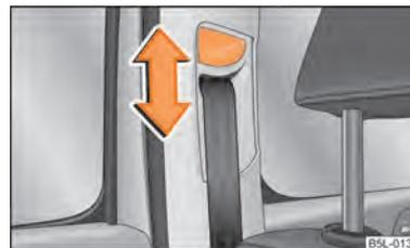
Fig. 119 Sedile anteriore: Regolazione dell'altezza della cintura
