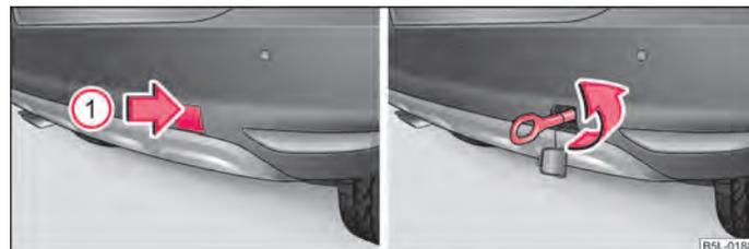
Fig. 176 Paraurti posteriore: Smontaggio della copertura / Montaggio dell'occhione di traino
