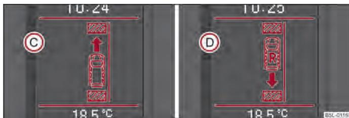
Fig. 103 Display informazioni: Avvertenza per l'innesto della marcia in avanti (C) o della retromarcia (D)
