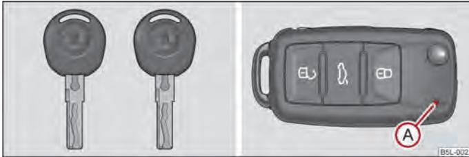
Fig. 9 Set di chiavi senza telecomando / chiave con chiave con comando a distanza
