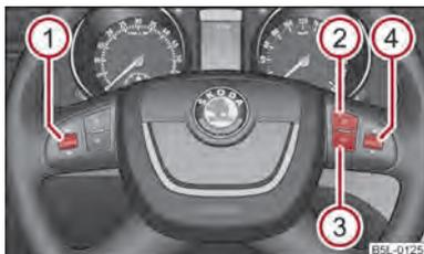
Fig. 112 Volante multifunzione: Uso del telefono
