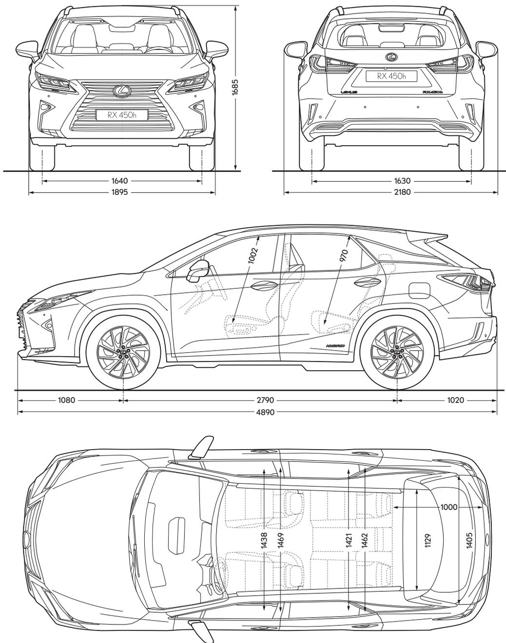
Da notare che le dimensioni illustrate/indicate sono misurate in millimetri.
