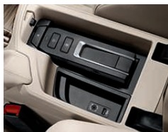
BMW Car Hotspot: consente di connettere contemporaneamente senza cavo ad Internet diversi apparecchi come ad esempio iPad, computer portatile o consolle giochi.
