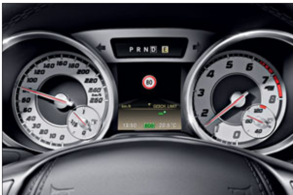
L'indicazione dello Speed Limit Assist compare sia sul quadro strumenti sia sul display centrale del COMAND Online.
