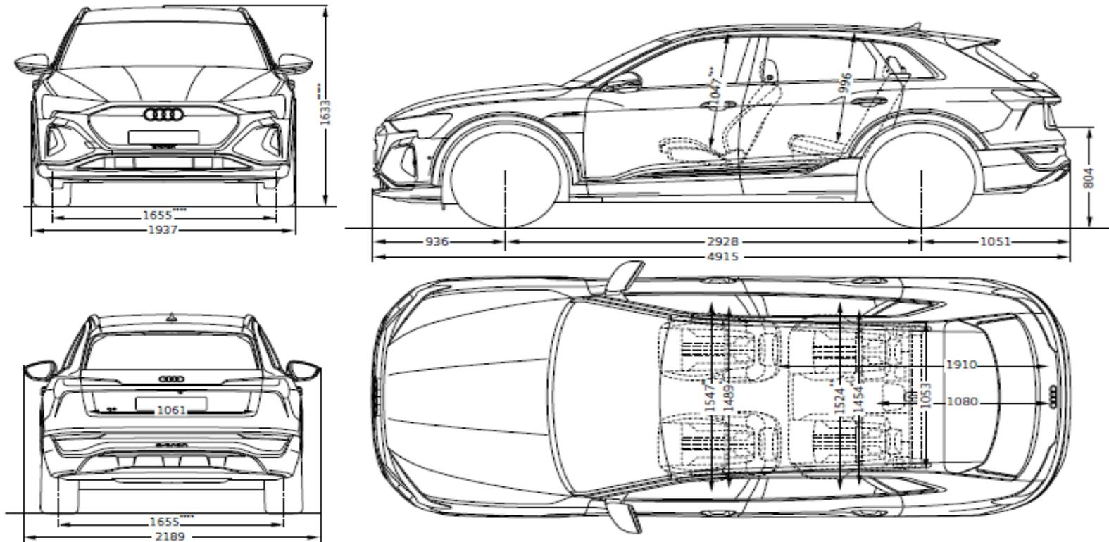
**Misure in millimetri** (indicazione delle dimensioni con massa a vuoto)
