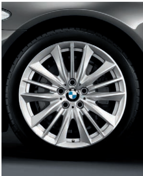
□ Cerchi in lega leggera da 19", styling a W n° 332 con pneumatici misti Runflat, ant. 8,5 J x 19, pneumatici 245/40 R 19, post. 9 J x 19, pneumatici 275/35 R 19.
