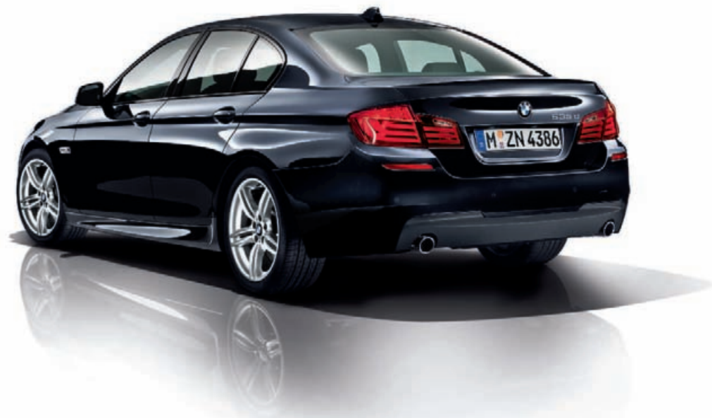
■ Diffusore posteriore: il diffusore posteriore incorporato migliora la deportanza al retrotreno e aumenta l'aderenza soprattutto ad alte velocità. L'aspetto sportivo è ulteriormente incrementato dai terminali cromati scuri.
