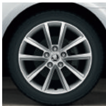
Cerchi in lega 7.0J x 17" Teron per pneumatici 225/45 R17 in design argento (5E0 071 497A 8Z8)
