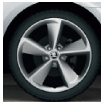
Cerchi in lega 7.5J x 18" Golus per pneumatici 225/40 R18 in design argento (5E0 071 498C 8Z8)
