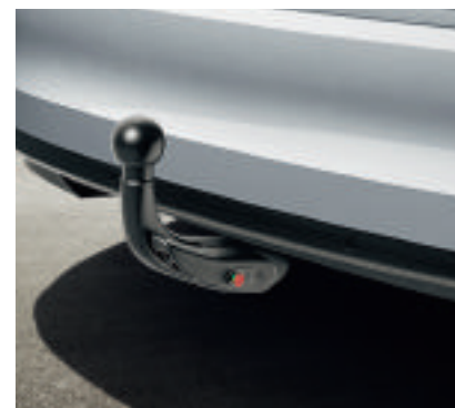
Gancio di traino smontabile (5E0 092 155) Kit elettrico con presa a 13 poli per vetture senza predisposizione di serie per gancio di traino (5E0 055 316A); per vetture con predisposizione di serie per gancio di traino (5E0 055 316)
