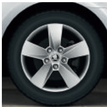
Cerchi in lega 6.5J x 16" Ilias per pneumatici 205/55 R16 in design argento (5E0 071 496D 8Z8)
