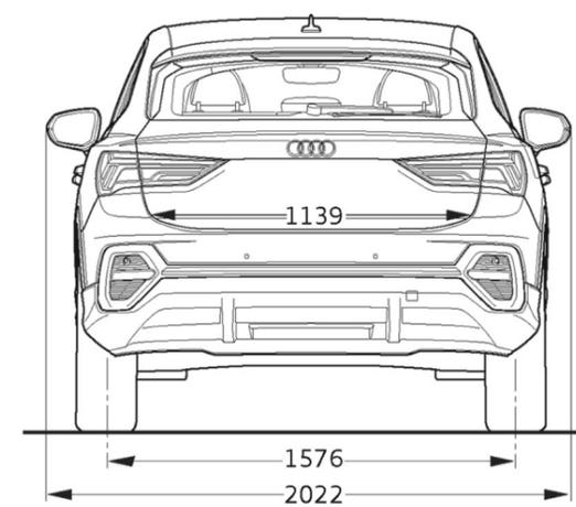
**NOTE:****Misure in millimetri** (indicazione delle dimensioni con massa a vuoto)
