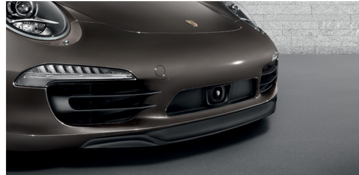
Sensore radar del sistema adattivo di regolazione della velocità (ACC)
