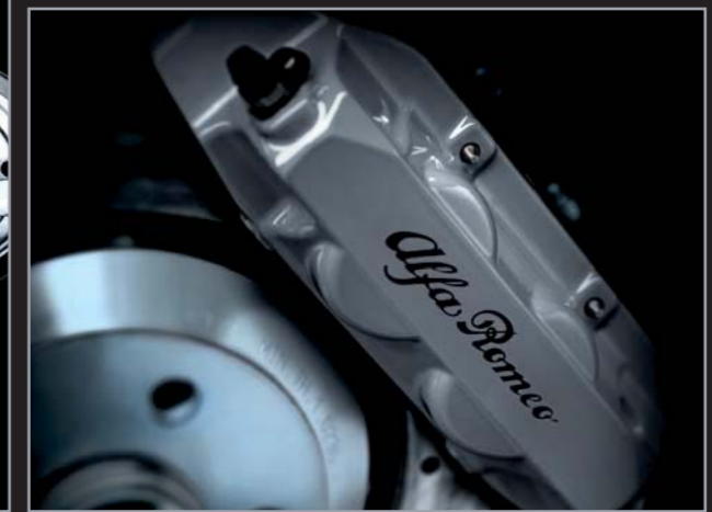
Freni anteriori Dual-cast autoventilanti forati 305x28 con pinza fissa a 4 pistoncini Brembo
