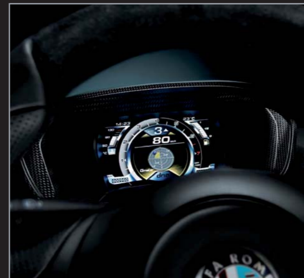
Quadro strumenti Full Digital con tecnologia TFT Palpebra quadro strumenti in fibra di carbonio
