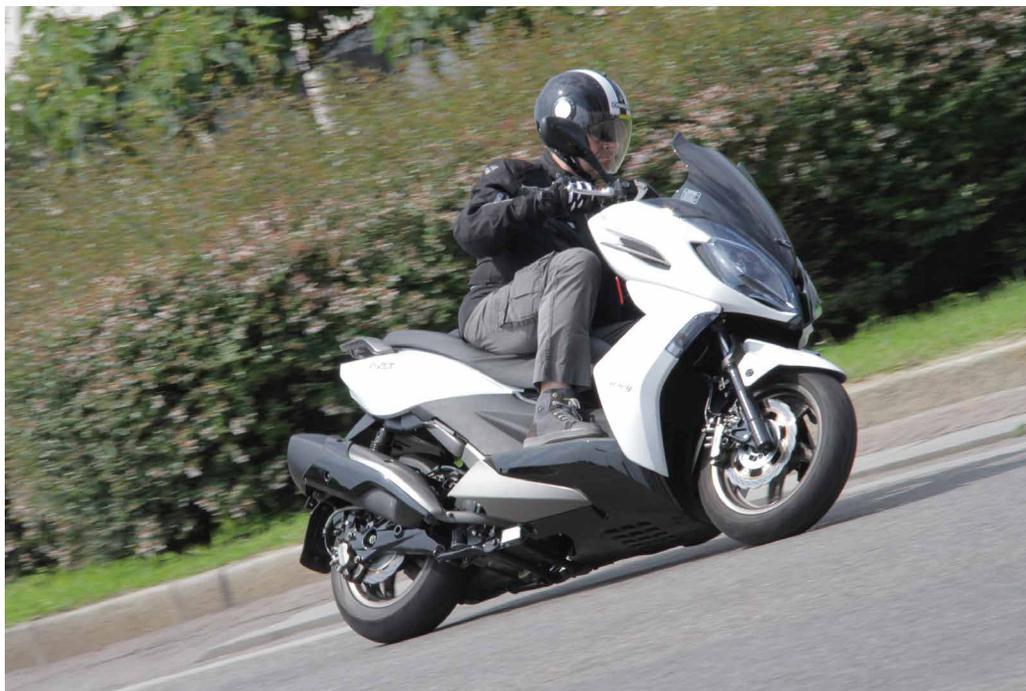
dichiara due cavalli in più (29,8/21,9 kW) a parità di giri, con 2,95 kgm (30,1 Nm) a quota 6.250. Da notare che questo motore G5 equipaggia anche la versione 2015 del "ruote alte" GTi.
