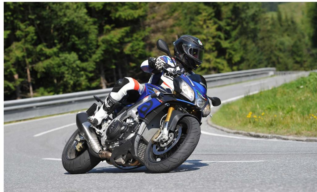
la Tuono 1100 è dotata di aQS, il quick shift, che permette cambiate rapidissime senza la necessità di chiudere il gas.
