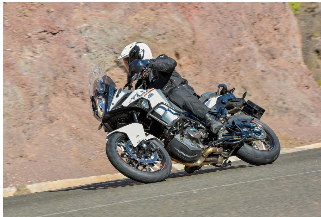
La 1290 Super Adventure adotta i bei cerchi a raggi della 1190 di tipo tubeless con pneumatici Continental Trail Attack 2 nelle misure 120/70-19 e 170/60-17. La frizione impiega una pompa idraulica Magura, mentre i freni sono marchiati Brembo. Davanti lavora la pompa radiale sulle pinze (anch'esse radiali) a quattro pistoncini, i dischi sono da 320 mm (267 dietro).
