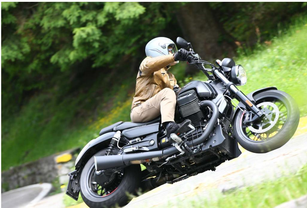
Moto Guzzi) calzano pneumatici 130/70R18 all'anteriore e 200/60R16. Freni all'altezza della situazione, con all'anteriore due dischi flottanti da 320 mm lavorati da pinze radiali Brembo a 4 pistoncini contrapposti e al posteriore un disco singolo da 282mm. Il tutto, naturalmente, gestito da un ABS a due canali che libera la mente da preoccupazioni indebite.
