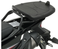
Piastra di supporto per bauletto City da 30 l
