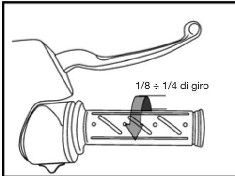
Se dopo 3-4 secondi il motore non si avvia ruotare leggermente la manopola dell'acceleratore (1/8 ÷ 1/4 di giro).
